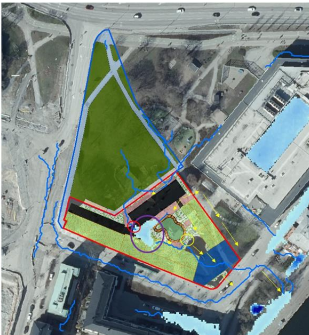
Figur 30: Befintliga flödesvägar (blå sträck), befintlig lågpunkt (lila ring), framtida flödesvägar (gula pilar), framtida lågpunkt (gul ring) samt känslig passage (röd ring). Bakgrundskarta: ArcGIS.
